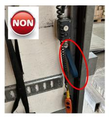
Ne pas mettre de sangles ou dragonnes qui pourraient se trouver sur le chemin de guidage de la porte ou qui pourraient se bloquer dans une roulette.
